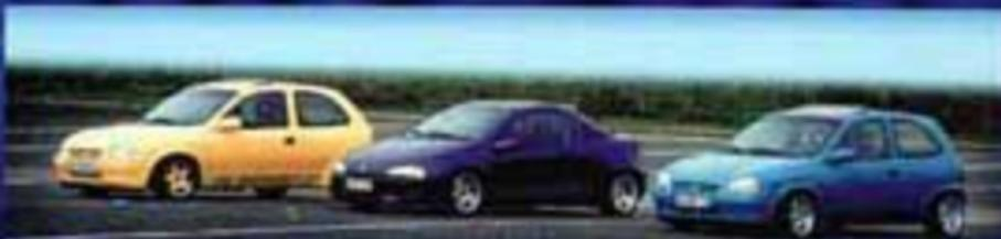
Durch geringen Karosserie Aufwand können beim Opel Corsa B Modell auf der VA und HA Folien in den Größen 7 x 14 ET 24 und 8 x 14 ET 15 problemlos verbaut werden. Es werden an der HA die Serienkraftflügelverbreiterungen angepasst, Radläufe gebördelt und eine Reifenfreiheit hergestellt. Anschließend werden die Originalverbreiterungen verklebt. Umbau ohne Lackierarbeiten möglich.
